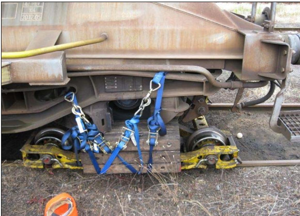
Abb.: 2 Kesselwagen mit Hilfsdrehgestell
