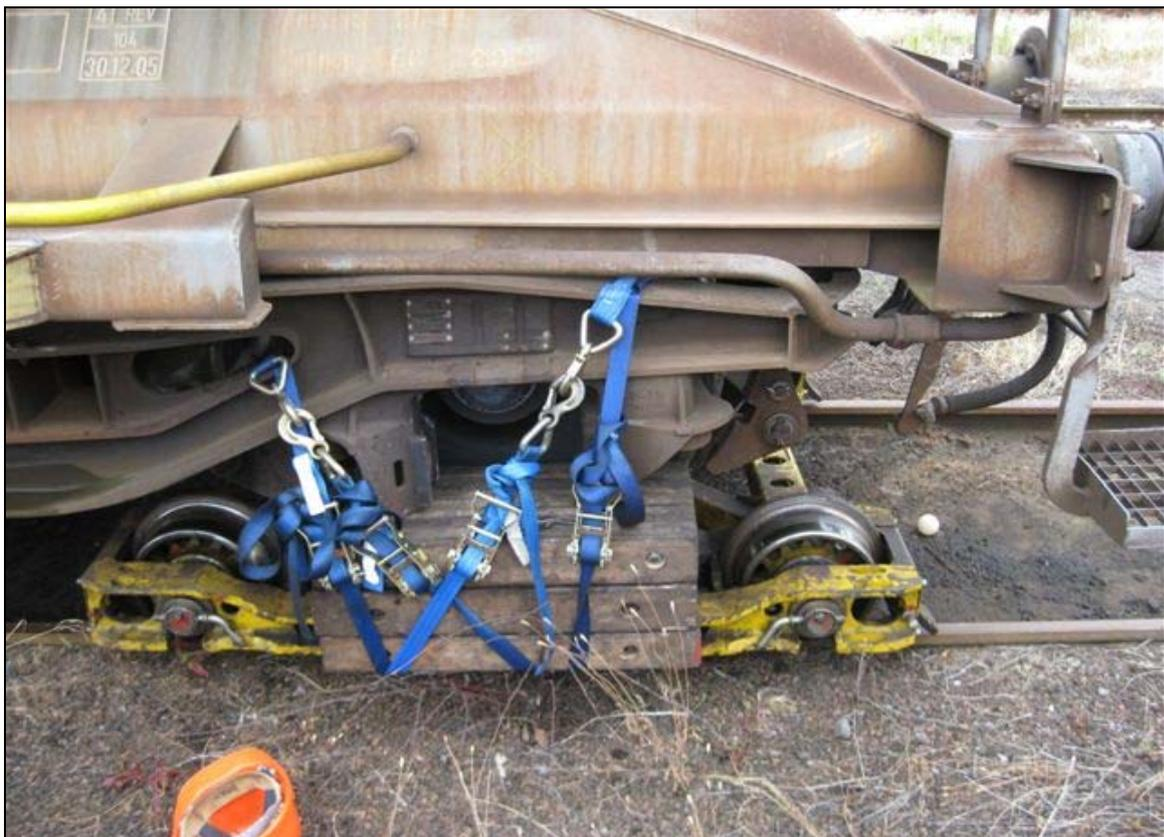
Abb.: 2 Kesselwagen mit Hilfsdrehgestell
