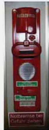
Wurde der Kipptaster „Notrufstelle“ von einem Fahrgast betätigt, wird Ihnen das durch Aufleuchten der Leuchttaste „Notbremse – Ruf“ am Fahrerarmaturenpult, und gleichzeitigem Erönen eines akustischen Signals übermittelt. In beiden Fällen ist sofort mit dem Fahrgast mittels Drücken der leuchtenden Wechselsprechtaste bzw. des linken Fußpedals mit folgenden Worten Kontakt aufzunehmen:
