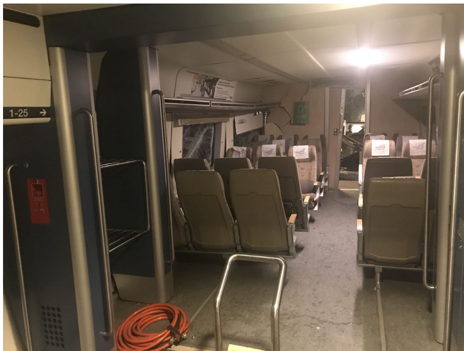
Figur 12. Invändiga skador i den främre vagnen. Foto: Gästrike räddningstjänst.
