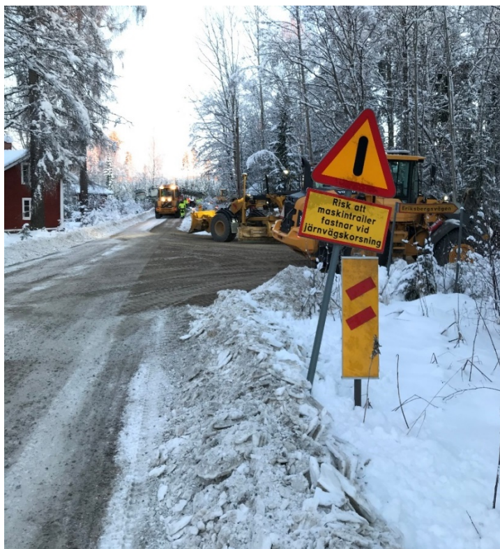
Figur 5. Före plankorsningen fanns varningsmärket (A40 "Varning för annan fara") med tilläggstavla "Risk att maskintrailer fastnar vid järnvägs-korsning" uppsatt. Foto: Olycksplatsansvarig från Infranord på uppdrag av Trafikverket. Fotot taget dagen efter olyckan.
