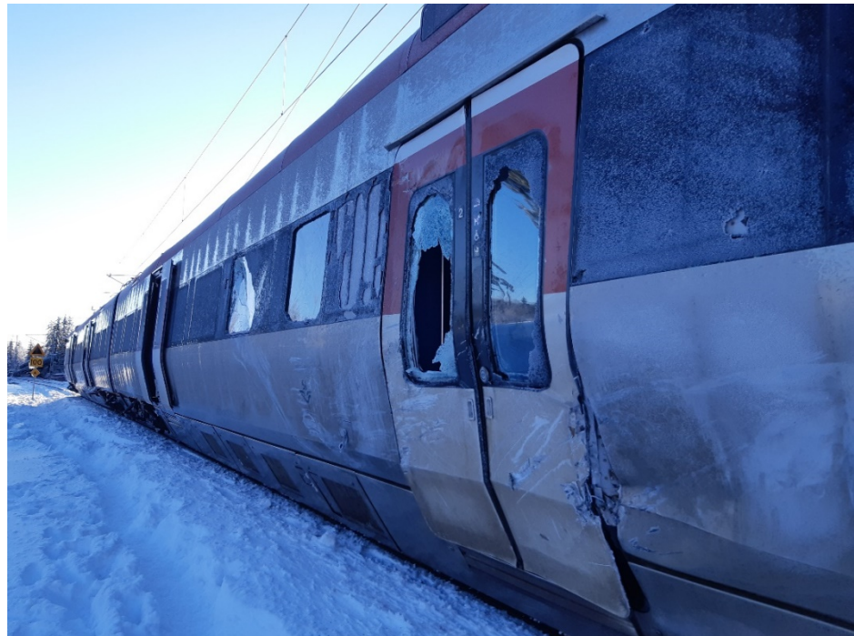
Figur 11. Utvändiga skador på den främre delen av tåget. Foto: SJ AB.
