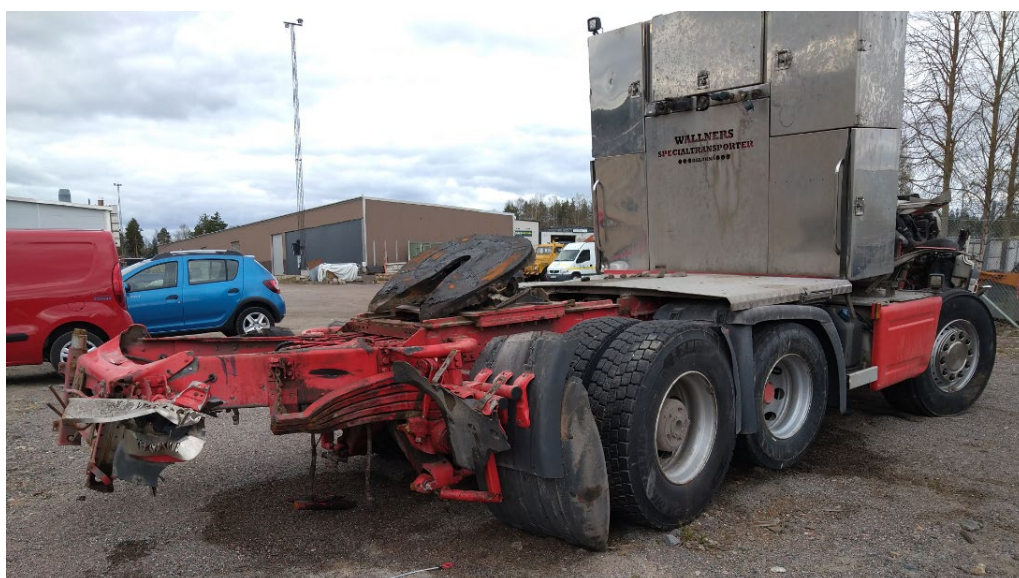
Figur 8. Deformationen på den bakre delen av lastbilen. Vändskivan är den svarta delen på flaket på lastbilen som trailern kopplas på.
