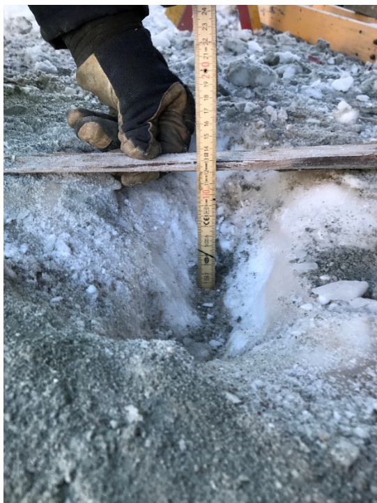
Figur 15. Isskorpa på 12 centimeter 3 meter från den rälen närmast trailern. Foto: Olycksplatsansvarig från Infranord på uppdrag av Trafikverket.
