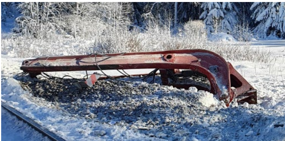
Figur 9. Trailerns så kallade svanhals. Den högra delen av svanhalsen fästs i lastbilens vändskiva, men infästningsanordningen separerade från svanhalsen. Bilden har spegelvänts för att på ett tydligare sätt relatera till figur 10 som visar hur tåget träffade lastbilsekipaget. Foto: Gästrikre räddningstjänst.
