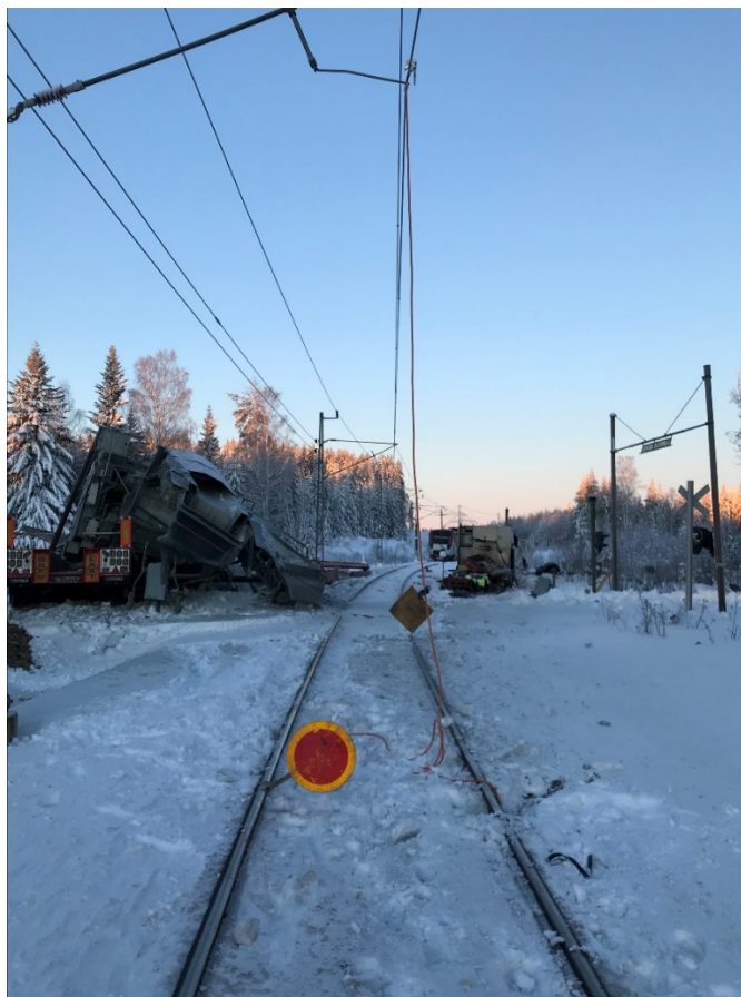
Figur 6. I förgrunden syns lastbilen på norra sidan av spåret och trailern och stenkrossverket på södra sidan av spåret efter kollisionen. I bakgrunden syns bakre delen av tåget som stannat efter plankorsningen. Foto: Olycksplatsansvarig från Infranord på uppdrag av Trafikverket.
