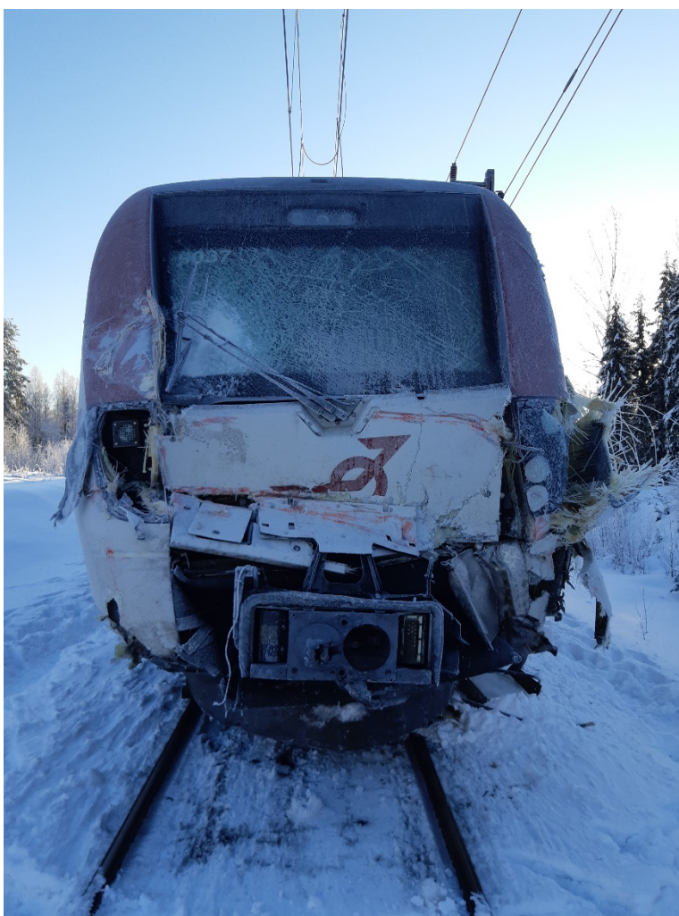
Figur 10. I fronten på tåget syns färgavskrap från där den så kallade svanhalsen på trailern blivit träffad av tåget. Foto: SJ AB.
