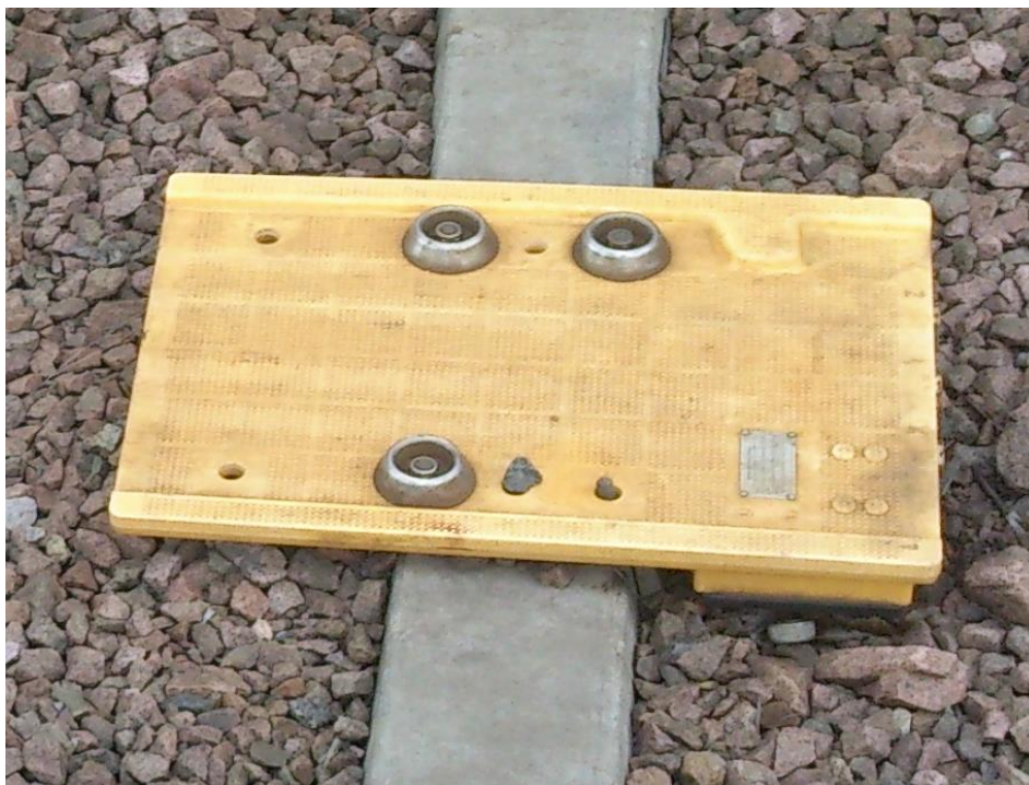
Figur 7. Hel balis med fästbrickor kvar (en bricka saknas).
