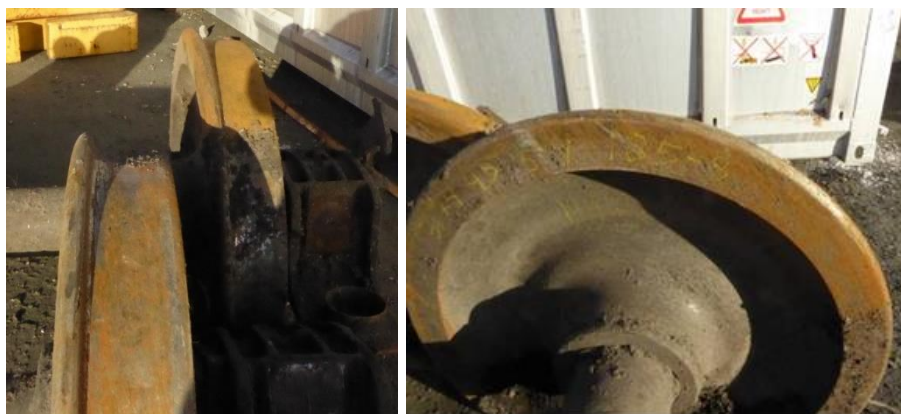
Figur 26. Exempel på flänsarnas skick efter urspårningen.
