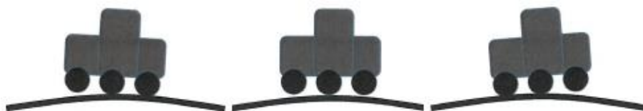
Figur 29. Illustration över hur ett treaxligt lok riskerar att belasta hjulaxlarna.
