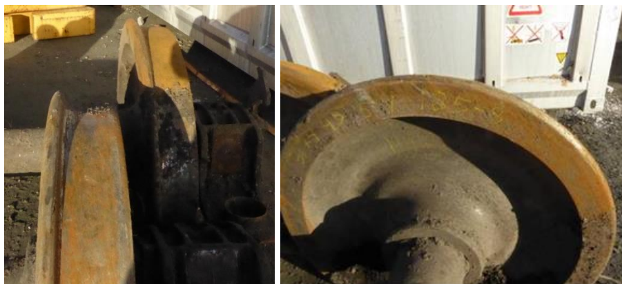
Figur 26. Exempel på flänsarnas skick efter urspårningen.
