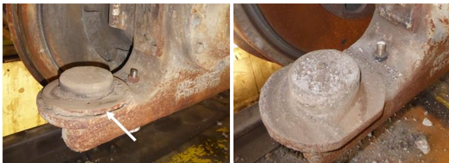
Figur 33. Till vänster: axel 3 med 12 mm shims. Till höger: Axel 1, utan shims.
