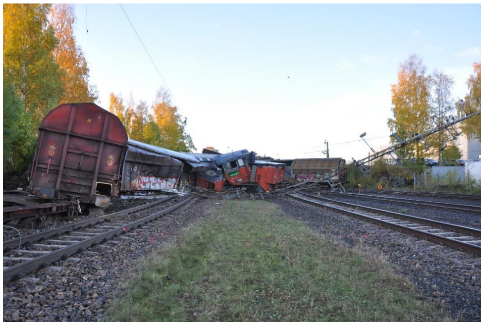
Figur 4. Bild mot tågets färdriktning som visar de första urspårade vagnarna. I mitten syns det V5-lok som gick i transport.
