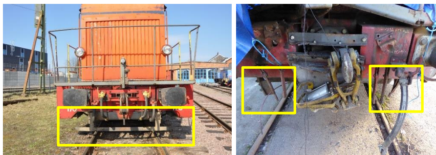
Figur 35. Till vänster gardjärn på V5 170 (i den gula ramen). Till höger visas fronten på det urspårade loket efter bärgning. Gardjärnets två infästningar är bockade inåt och bakåt (i de gula ramarna).
