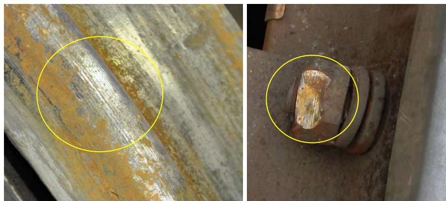
Figur 34. Delförstoring av en fläns på V5-loket samt en bult utmed vänster räl i växel 468.
