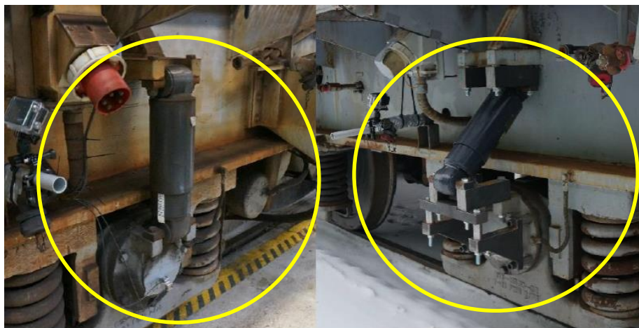
Figur 30. Bilder på en vertikal respektive vinklad stötdämpare på ett ursprungligt respektive provombyggt lok av typen V5. Foto: Green Cargo.
