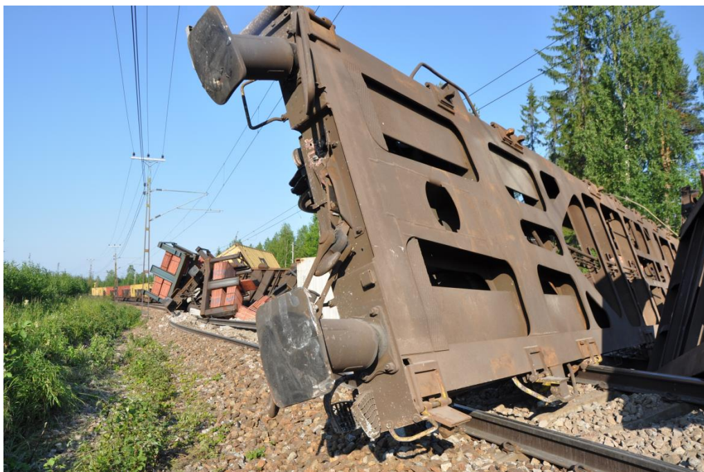
Figur 1. Bakre delen av tåg 4343; urspårade vagnar.
