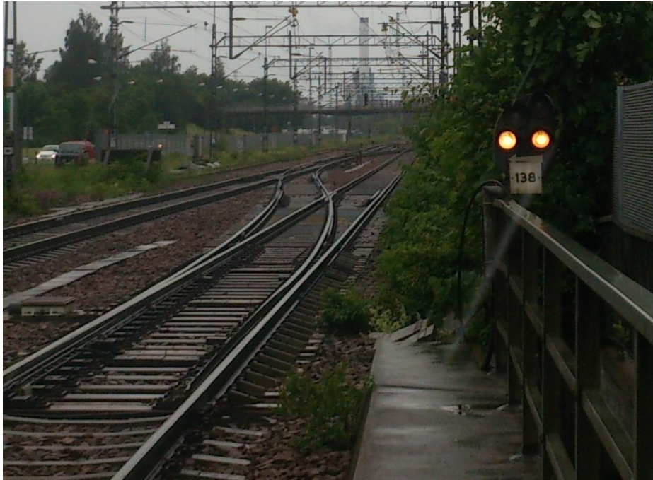
Figur 2. Växlingsdvärgsignal Vå 138. Signalbilden "Stopp" visas.
