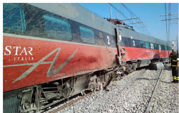
Figura 6. Foto relative allo svio del primo carrello della seconda carrozza e allo spostamento della parte anteriore della vettura di testa (con deragliamento del primo carrello)
