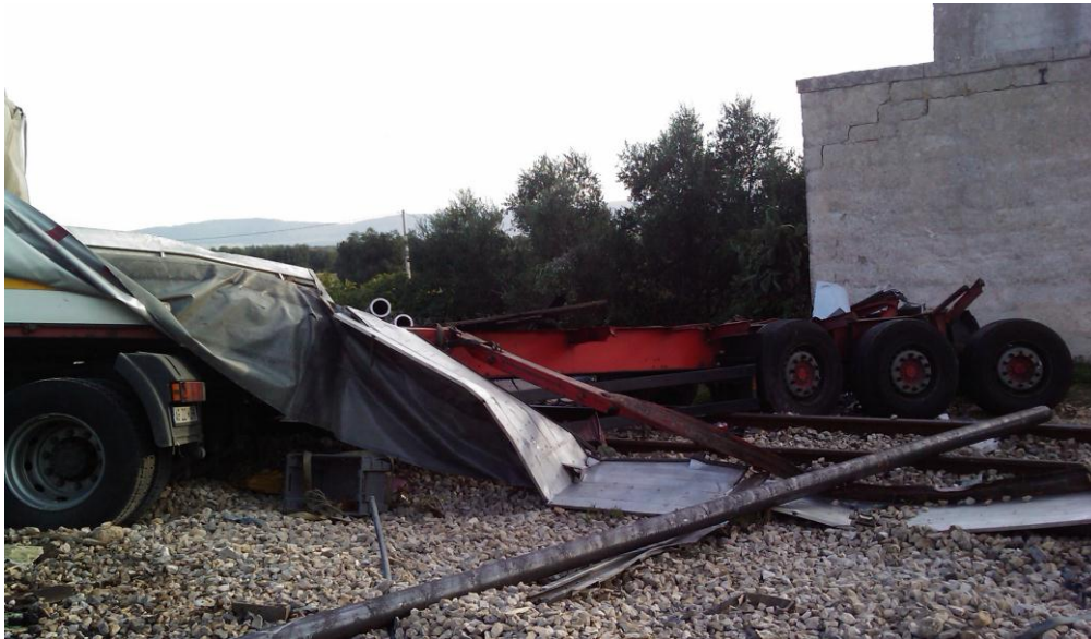
Figura 5. Foto dell'autoarticolato dopo la collisione: si osserva il rimorchio rimasto incastrato nel muro di un fabbricato adiacente la sede ferroviaria
