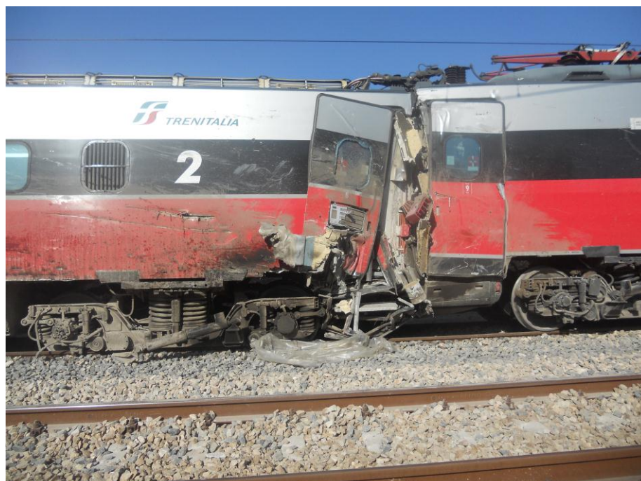
Figura 4. Foto dei danni riportati dal treno ES AV 9351 in corrispondenza dell'aggancio tra le prime due vetture di testa
