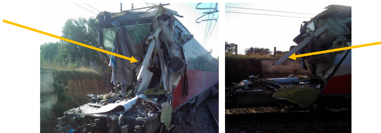
Figura 11 . Foto che evidenziano i montanti della cabina di guida dell'ETR485 coinvolto nell'incidente
