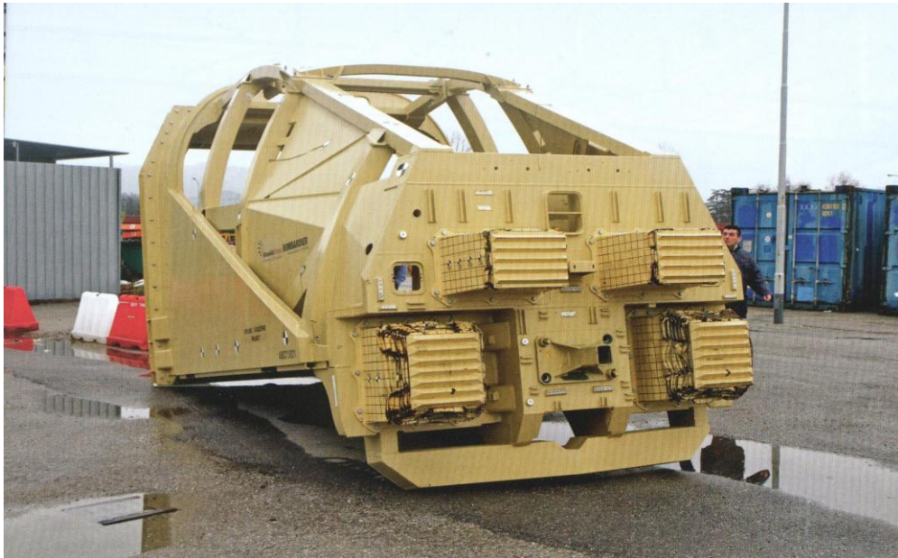
Figura 12 . Foto relative alla struttura della cabina di guida di un treno di recente concezione
