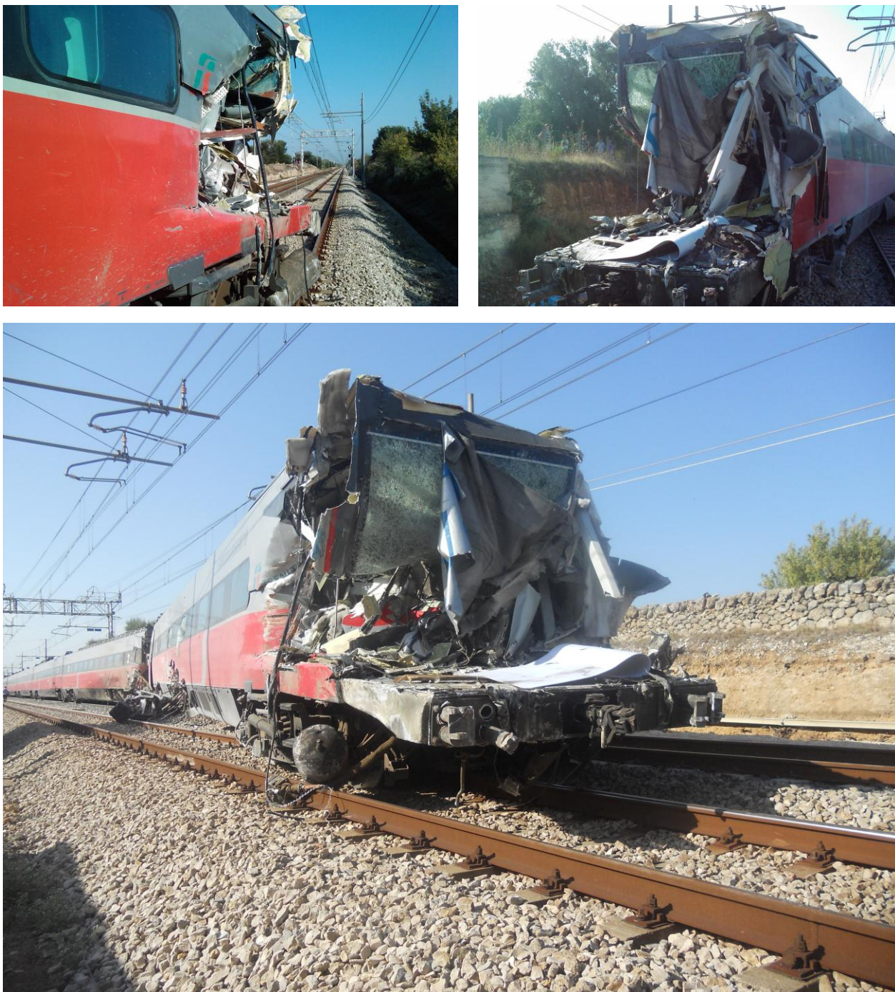
Figura 3. Foto dei danni riportati dalla cabina di guida (completamente distrutta) del treno ES AV 9351
