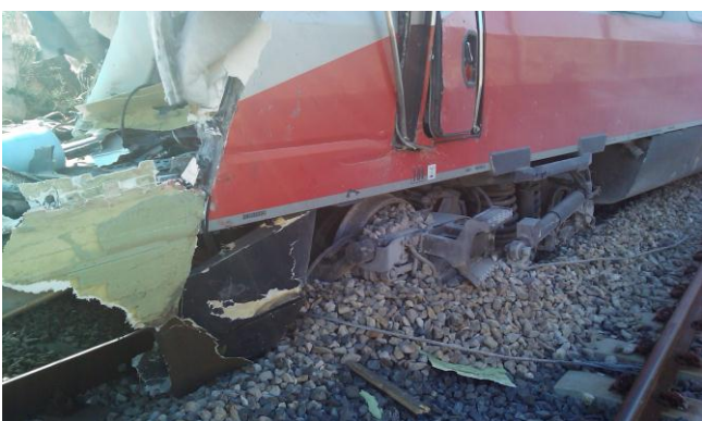
Figura 6. Foto relative allo svio del primo carrello della seconda carrozza e allo spostamento della parte anteriore della vettura di testa (con deragliamento del primo carrello)
