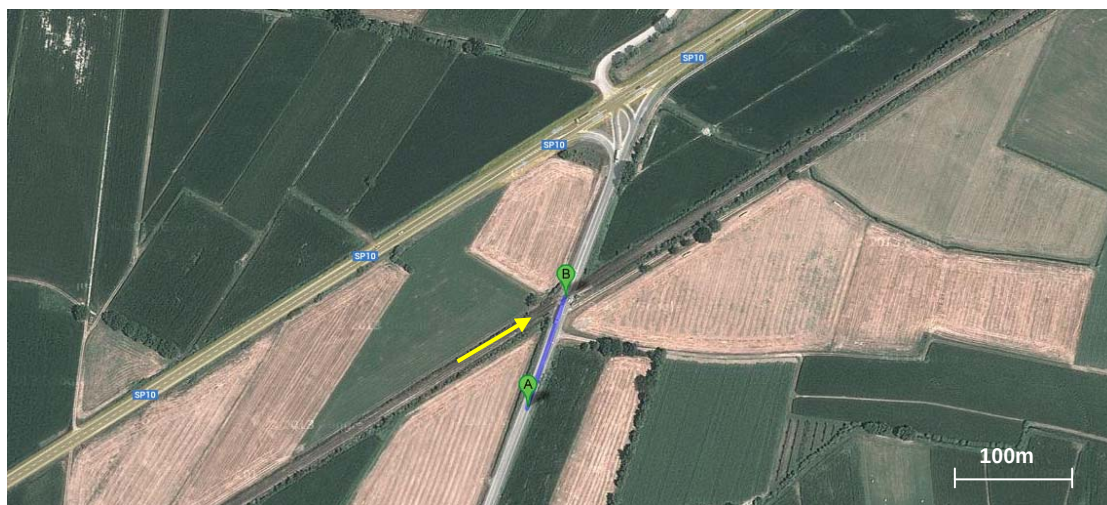
Figura 2: Vista aerea del PLA km 65+637 (fonte internet, Google maps). Il percorso da A a B corrisponde a quello effettuato dal conducente del motociclo investito nell'approccio all'attraversamento del PL. Il treno investitore proveniva dalla direzione indicata dalla freccia gialla.
