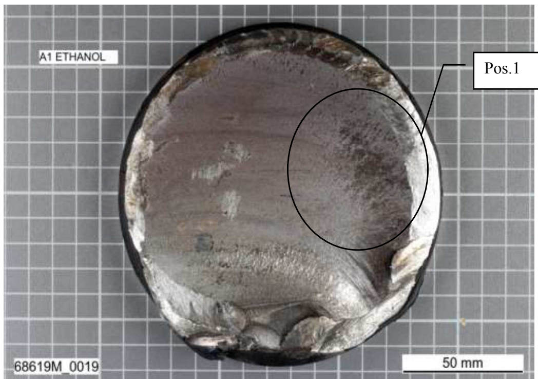
Figura16: Superficie di rottura troncone corto ruota - superficie pulita con ultrasuoni in bagno di etanolo
