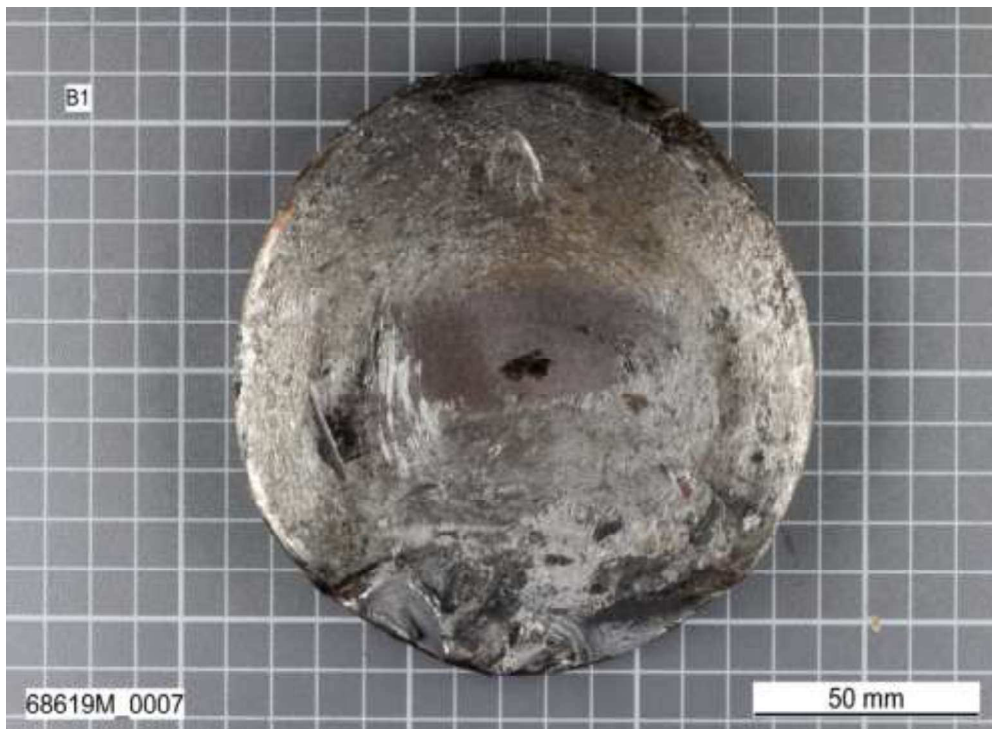
Figura18: Superficie di rottura troncone lungo assile - condizioni della superficie all'arrivo in laboratorio
