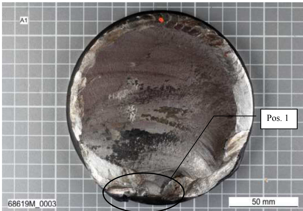
Figura14: Superficie di rottura troncone corto ruota - condizioni della superficie all'arrivo in laboratorio
