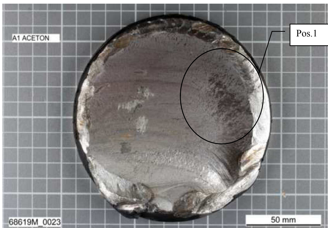
Figura17: Superficie di rottura troncone corto ruota - superficie pulita con ultrasuoni in bagno di acetone
