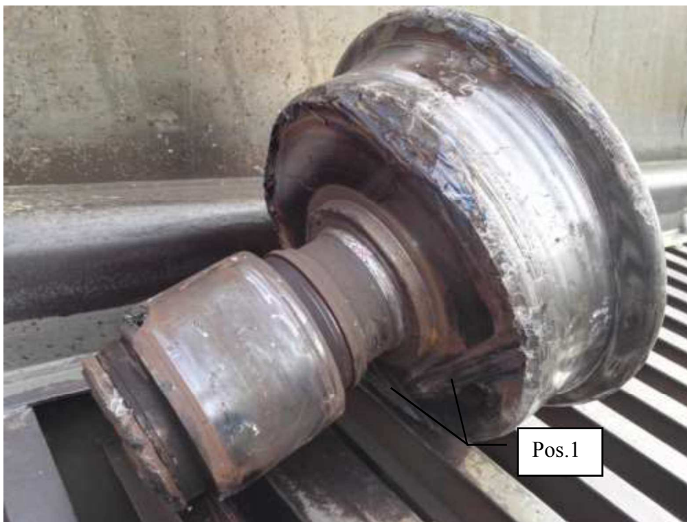
Figura19: Ruota lato boccola – rimasta incastrata tra il telaio del carrello e la infrastruttura.
