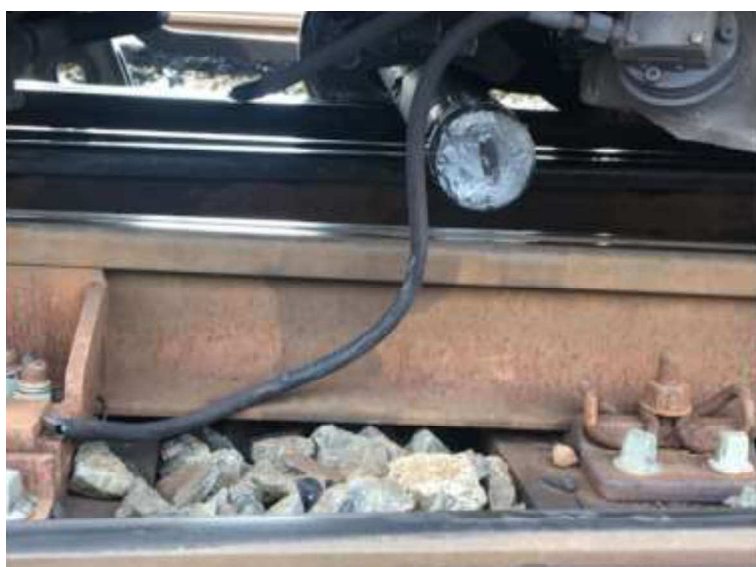
Figura 5: Superficie di frattura dell'assile: lato lungo assile.
