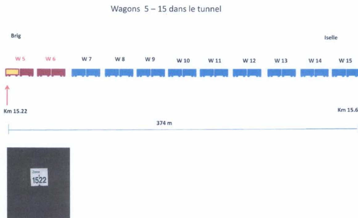
Figura 4 – Parte del convoglio rimasta all'interno della galleria. In rosso i carri su cui ha avuto origine l'incendio
