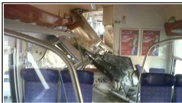
Figure 17 : Vue n° 6 - Le bras de la grue mobile traversant l'automotrice de tête
