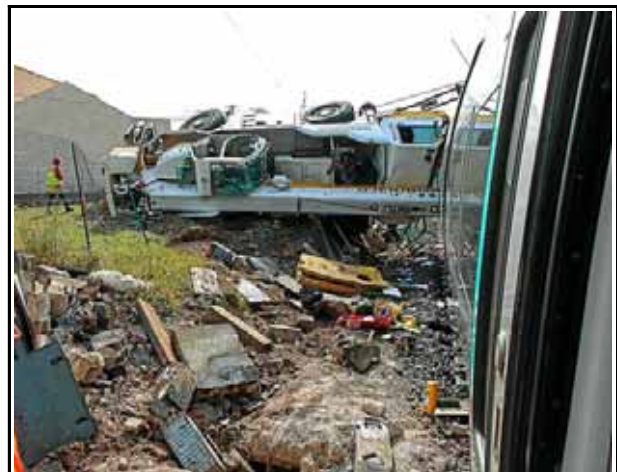
Figure 13 : Vue n° 2 - La grue mobile avec son bras encastré dans l'automotrice de tête, vue dans le sens de circulation du train
