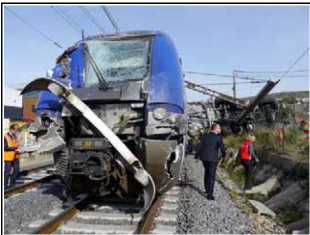
Figure 12 : Vue n° 1 - L'avant de l'automotrice de tête accidentée, avec à droite la grue mobile
