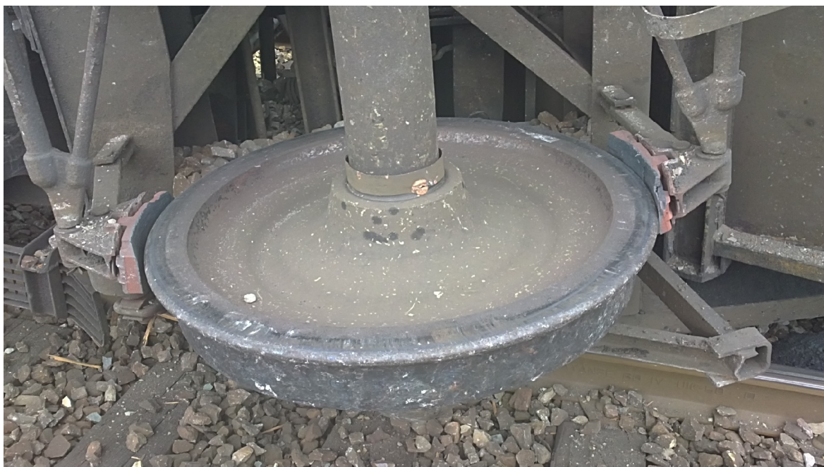
Illustration 12 : Essieu 3-4 avec ses semelles de frein très usées
