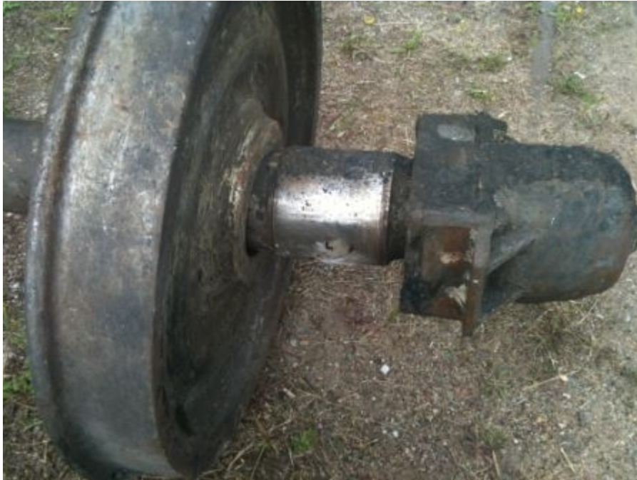
Illustration 11 : Roue décalée sur essieu 7-8
