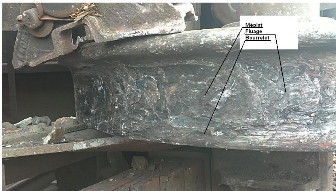
Illustration 10 : Roue de l'essieu 5-6 avec méplat, fluage et bourrelet
