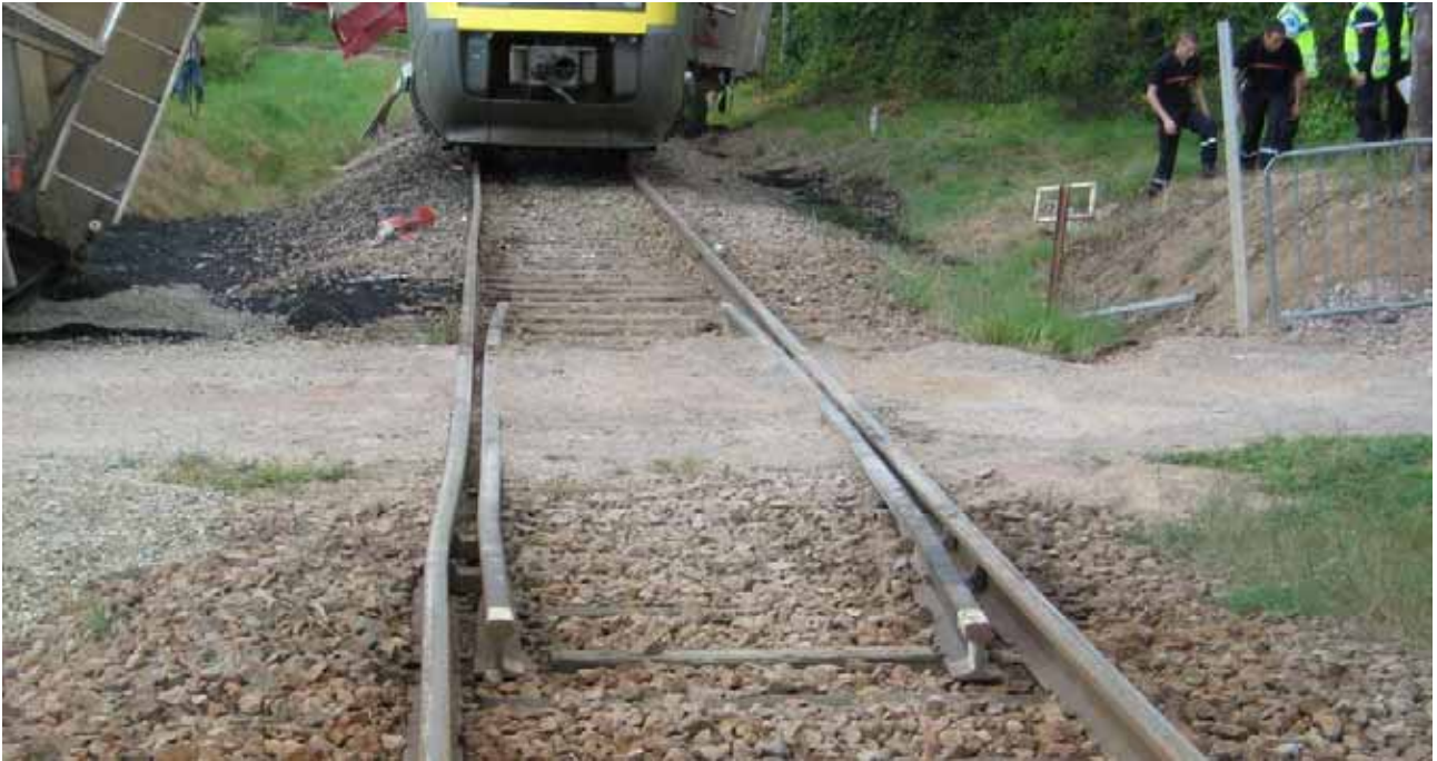
Photo n° 5 : Le passage à niveau juste après l'accident. La chaussée est abîmée par le passage des camions de chantier. Le rail gauche s'est déformé lors du choc et du déraillement.
