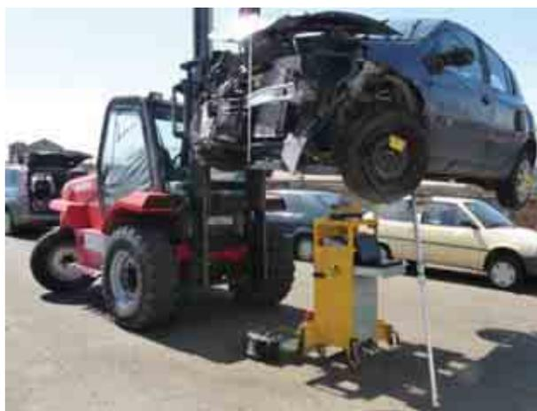
Les données prélevées sont mises en forme dans le repère orthonormé suivant où le point d'origine est le centre avant du véhicule, l'axe des abscisses est la longueur et l'axe des ordonnées sa largeur. Afin de bien illustrer le contact qui s'est produit entre la voiture et le parapet. L'arête verticale formée par le contact entre le coin du parapet et la voiture est le point 63.
