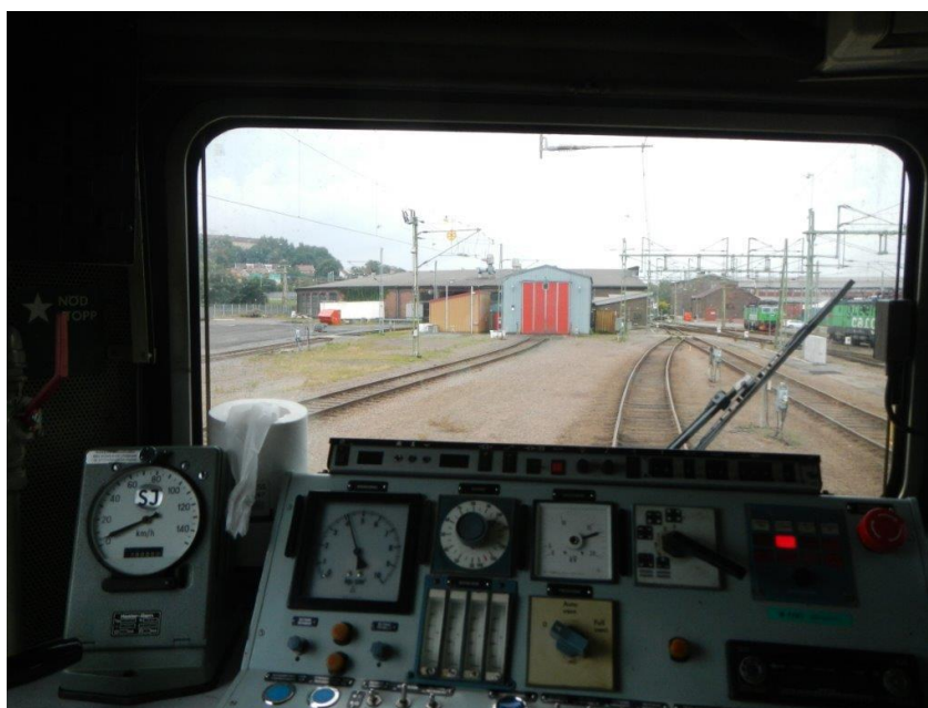
Figur 11. Vissa begränsningar i förarens siktfält uppstår på grund av hyttens konstruktion på den aktuella loktypen, med kraftiga hörn- och mittstolpar. Fotografiet är taget på Sävenäs rangerbangård i ett lok av samma typ som tåg 79012 bestod av.
