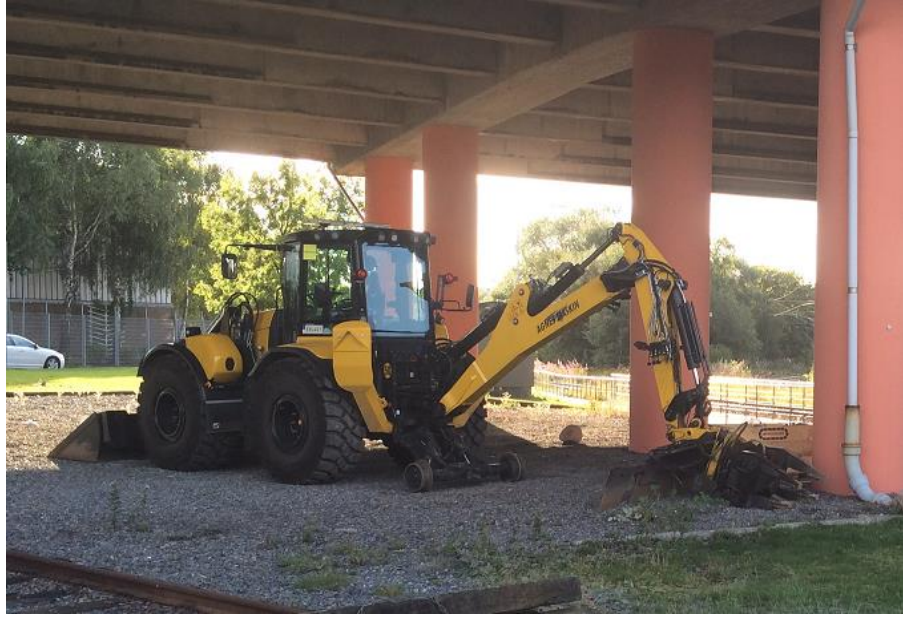
Figur 2. Grävlastaren som användes för slipersbytet. Foto: Niklas Andersson, Strukton Rail AB.
