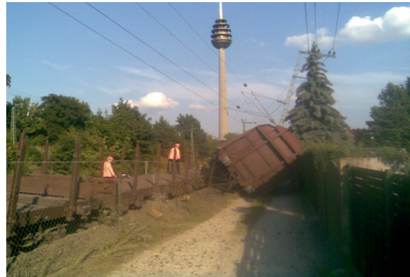
entgleiste Wagen 11 und 12 (Bogeninnenseite)
