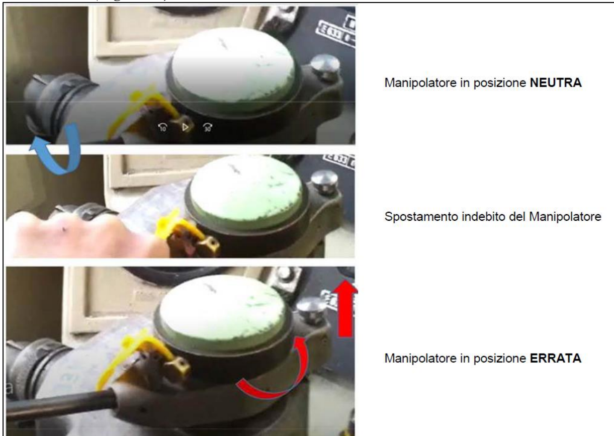
Figura 12 – Manipolatore Oerlikon su vettura pilota (fonte: Trenord)
