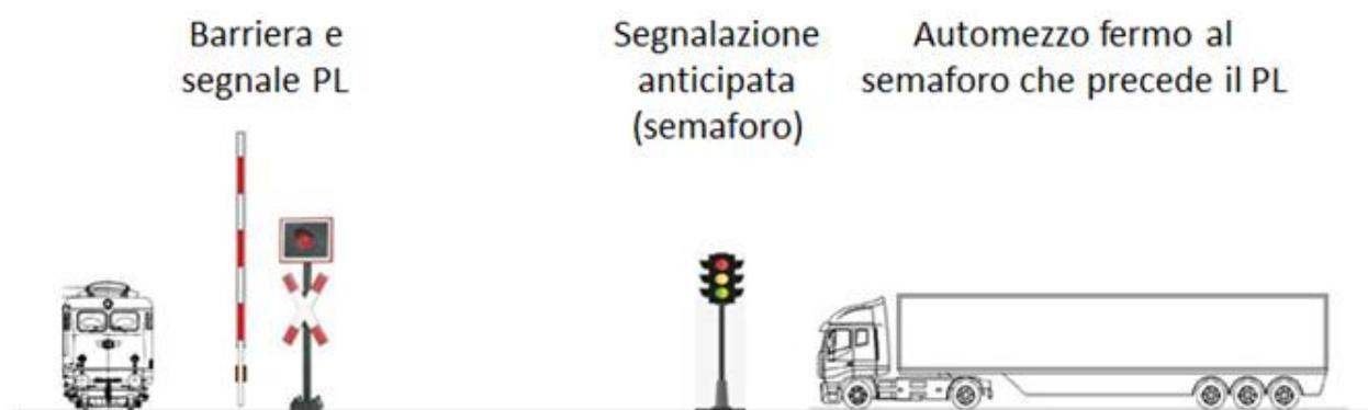
**Figura 35 - Semaforo stradale di ripetizione del dispositivo di segnalazione luminosa del PL**
