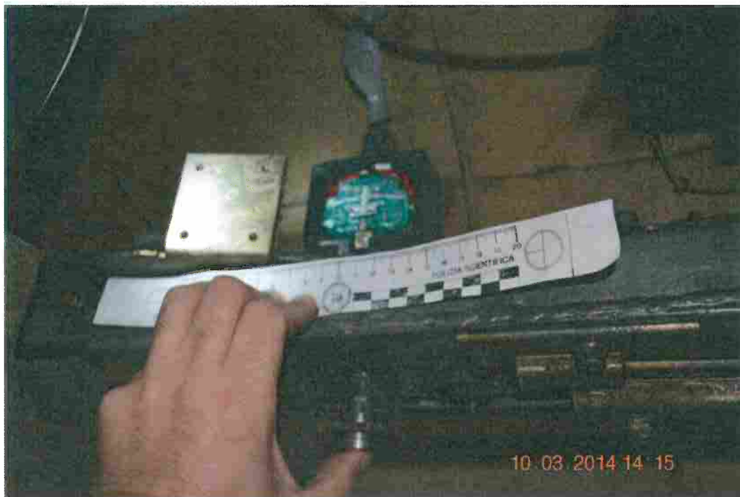
Figura 39 - Microswitch e palpatore di azionamento in posizione di porta chiusa (Foto Polizia Scientifica)
