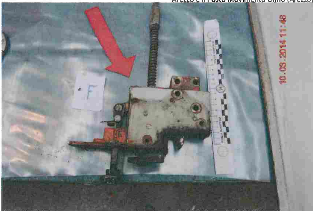
Figura 36 - Complesso chiavistello smontato (Foto Polizia Scientifica)
