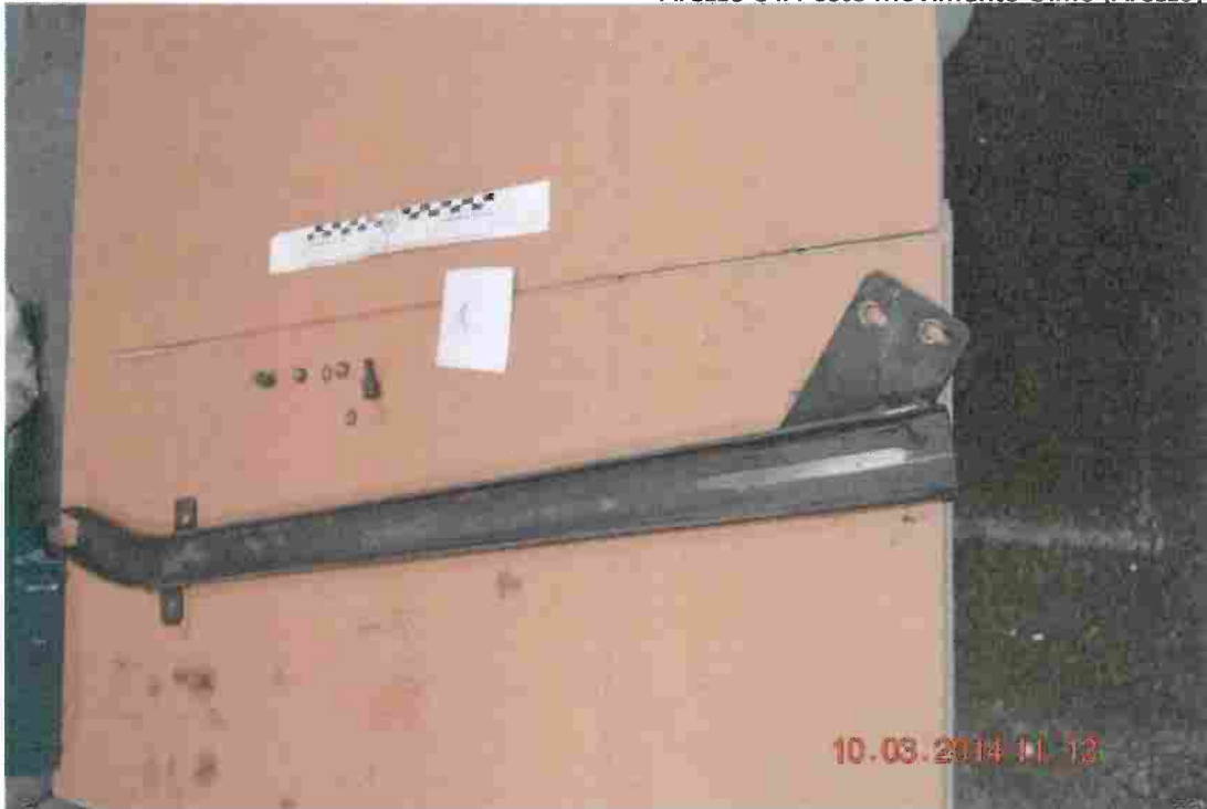
Figura 34 - guida scorrimento inferiore anta
