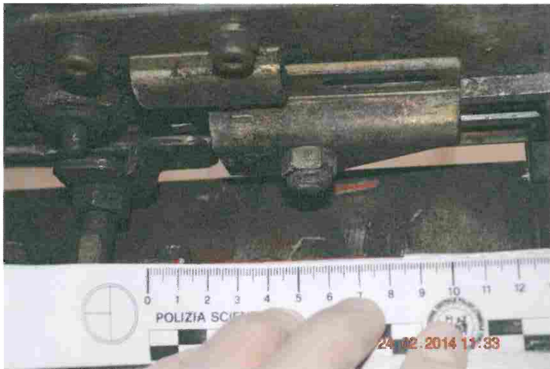
Figura 28 - Meccanismi sporchi e "impastati" (Foto Polizia Scientifica)
