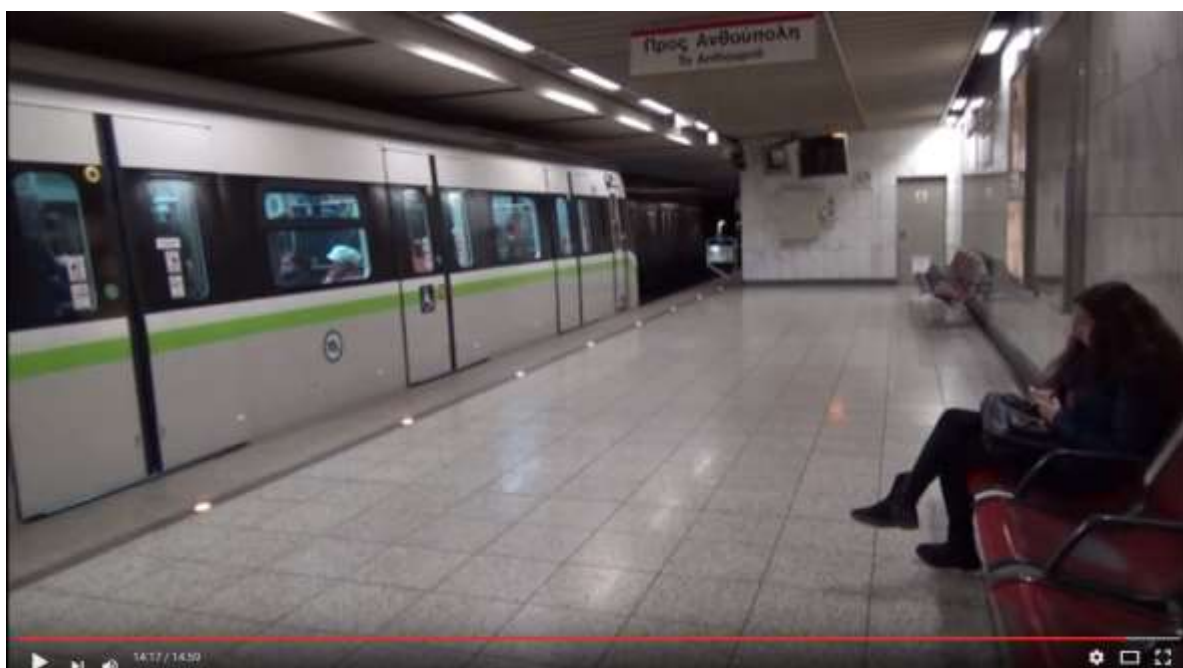
Foto n. 11c - Esempio di delineatori di margine a LED per banchine. Atene - Metro Linea 2 Fotogramma https://www.youtube.com/watch?v=x-MENqYVvcY
