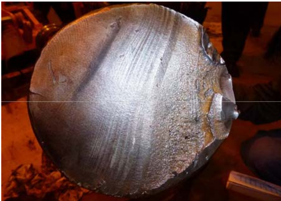
Vista de la rotura del eje en el taller de la empresa
