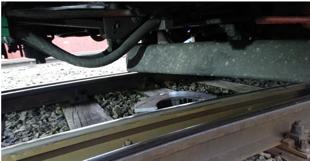
4. ábra: a letört féktárcsa darab a 6. sz. kitérő közbelső részén
