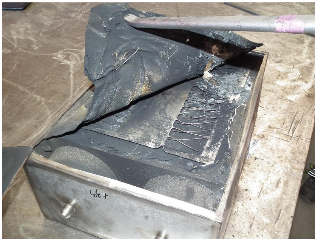
2. ábra: a kondenzátor belseje
