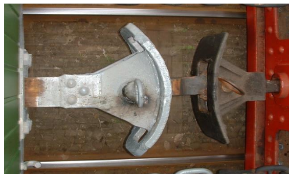
2. ábra: a keskenynyomközű vasutak jellegzetes kapcsolókészüléke
