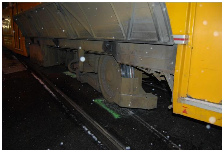
4. ábra: A december 27-én kisiklott villamos
