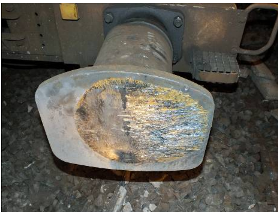
8. ábra: Kenetlen rugótányér, bemaródásokkal az egyik siklott járművön
