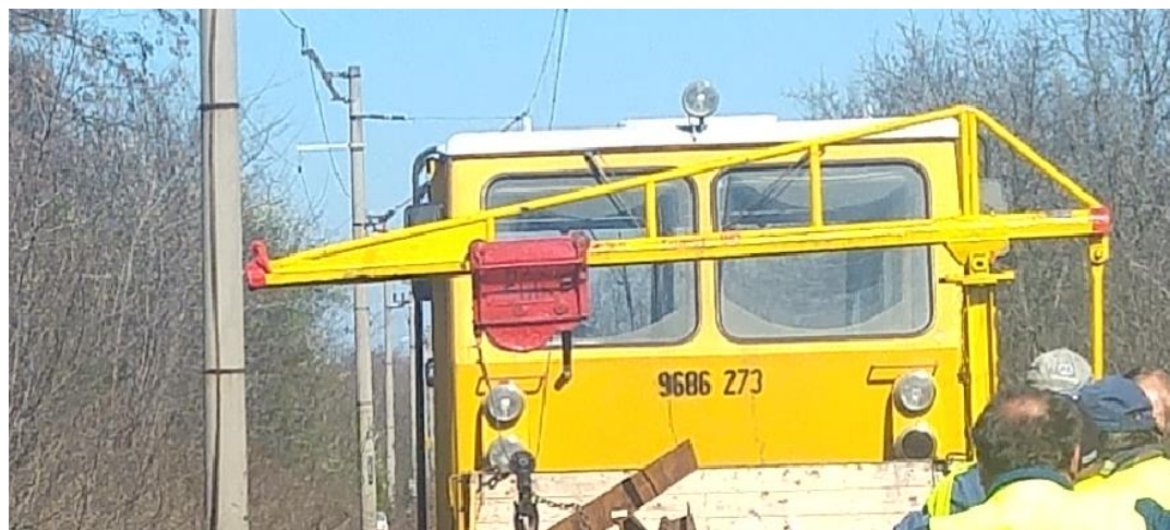
9. ábra: A kihajtott darugém
