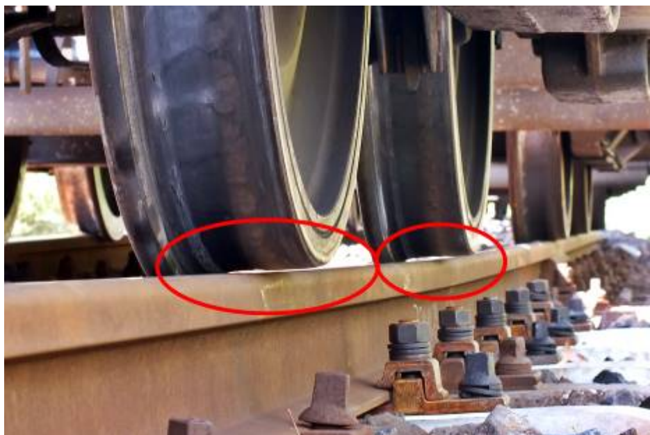
18. ábra: Sínkoronától elemelkedett futófelület (2015. szeptember 15.)
