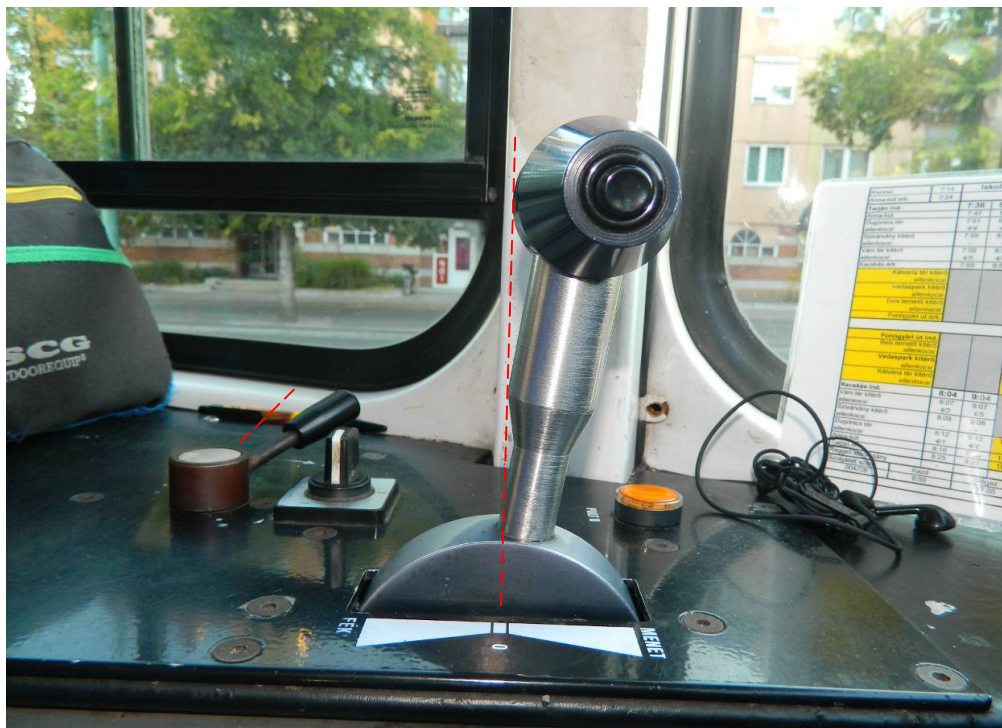
10. ábra: az irányváltó és vezérlőkar, ahogy az üzembentartó helyszínelője lefényképezte (a szaggatott vonalak a „0” állásokat jelzik)
