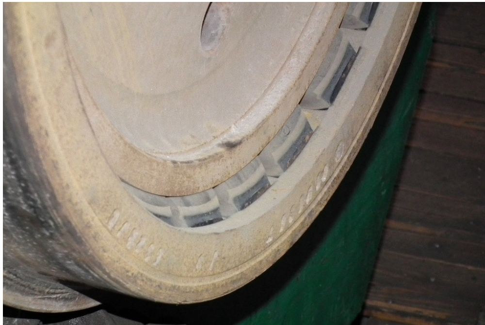
6. ábra: a gumirugók a sajtolásos próba végkitérésénél
