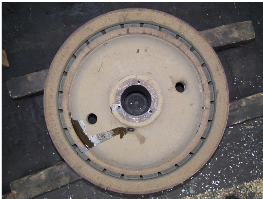
5. ábra: jól láthatóak a gumirugók a kerékben
