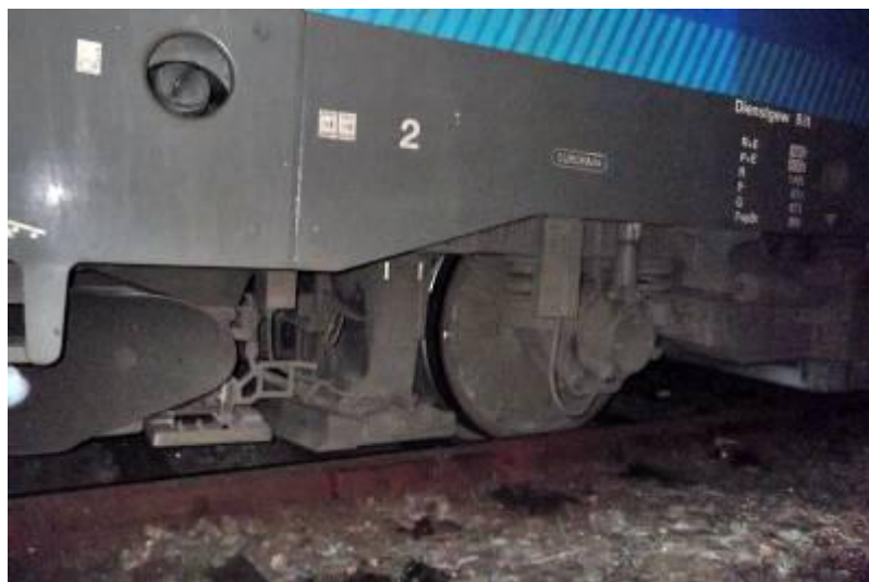
3. ábra: A kisiklott jármű az eset helyszínén (forrás: MÁV Zrt.)
