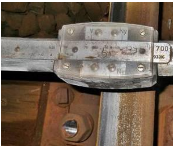
5. ábra: Üzembeszüntetési határt elérő mért nyomtáv a siklást követően. (Forrás: MÁV Zrt.)
