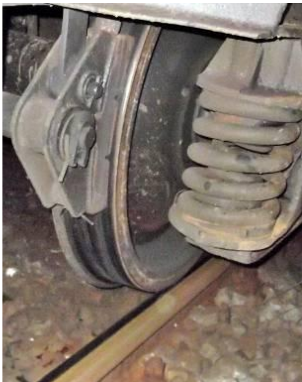
11. ábra: Nyomtáv bővülés nyoma az eset helyszínén (A képen a vonatba sorozott első kocsi első forgóváza látható)
