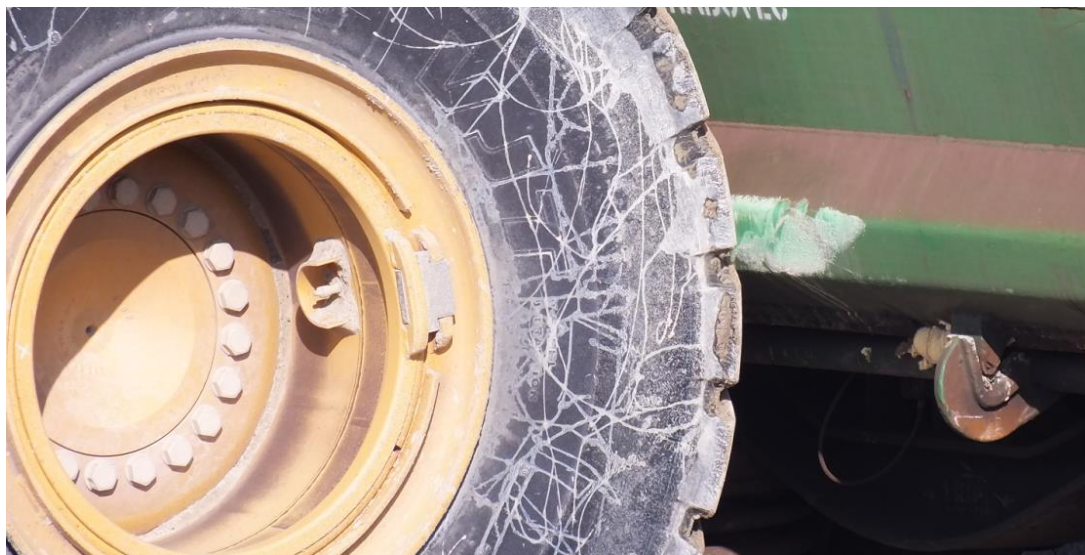
9. ábra: Keréknyomok a vasúti kocsi oldalán
