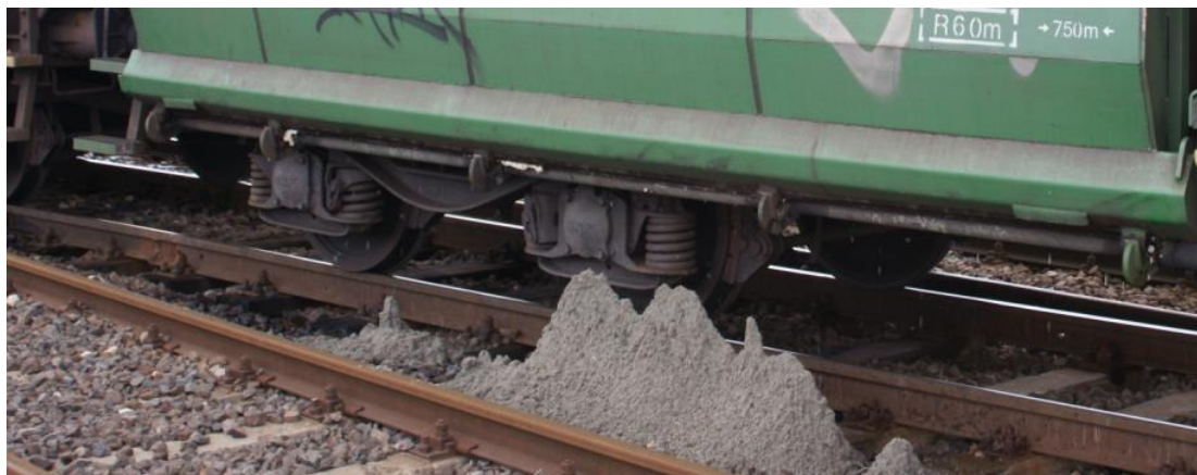
9. ábra: A kifolyó víz, és a sóderszemcsék
