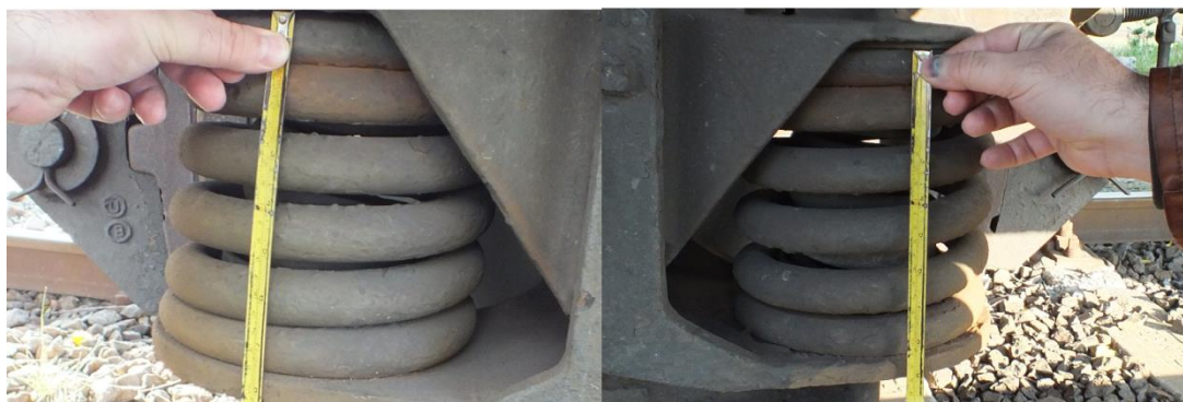
8. ábra: Az összenyomott rugók közötti különbség 2 cm
