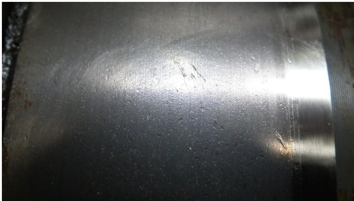
12. ábra: a sérülttel átellenes oldali csapágygyűrű felülete
