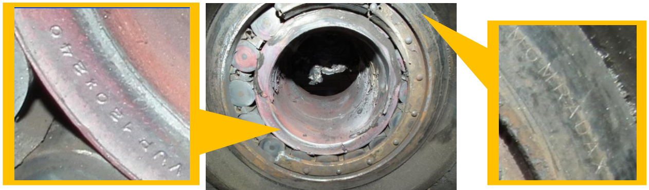
6. ábra: a balesetet okozó sérült csapágyazás (csapágy típusa, gyártó jele)
