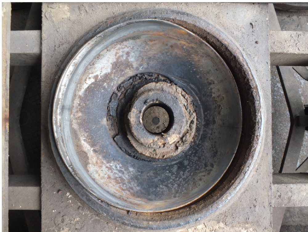
6. ábra: a forgótányér-betét helyzete
