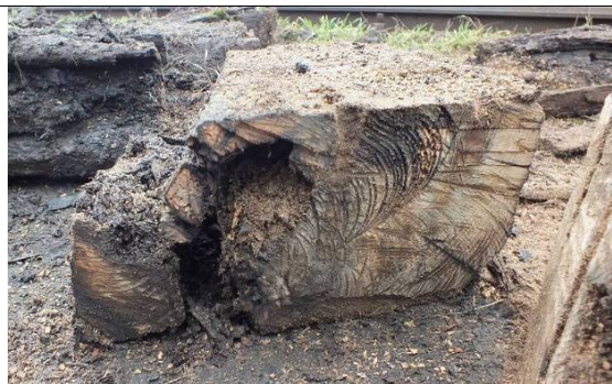
7. ábra: metszet a síncsavarok síkjában
