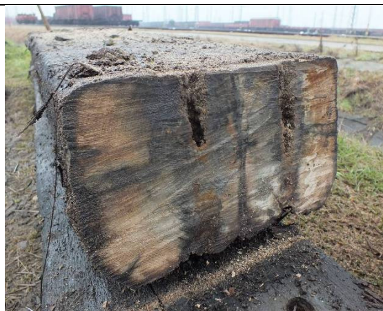
6. ábra: metszet a síncsavarok síkjában
