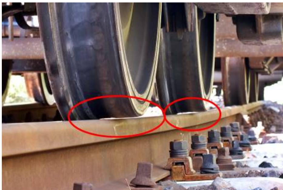
18. ábra: Sínkoronától elemelkedett futófelület (2015. szeptember 15.)
