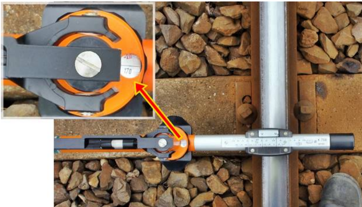
14. ábra: Túlemelés-érték a második siklás helyszínén (2015. július 27.)
