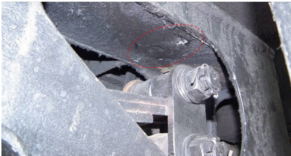
3. ábra: felütközési nyomok a forgóvázban
