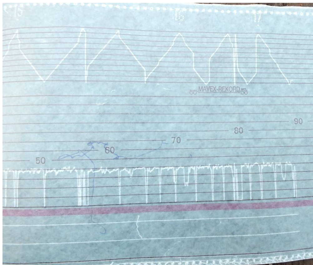
5. ábra: a mozdony adatrögzítő-szalagja
