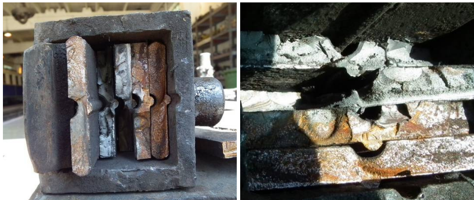
4. ábra: az eltört laprugó és törési felületei
