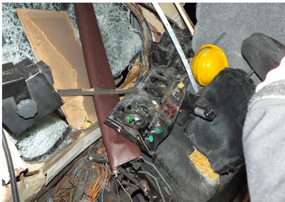
5. ábra: az összenyomódott vezetőtér
