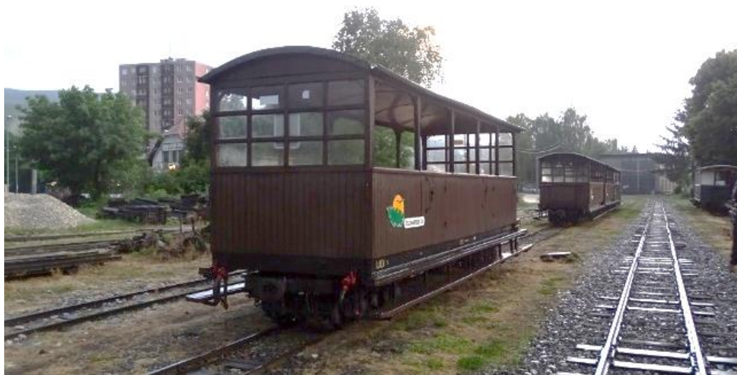
6. ábra: Majláth állomás III. vágányán leállított kocsik, alájuk tett saruk nélkül
