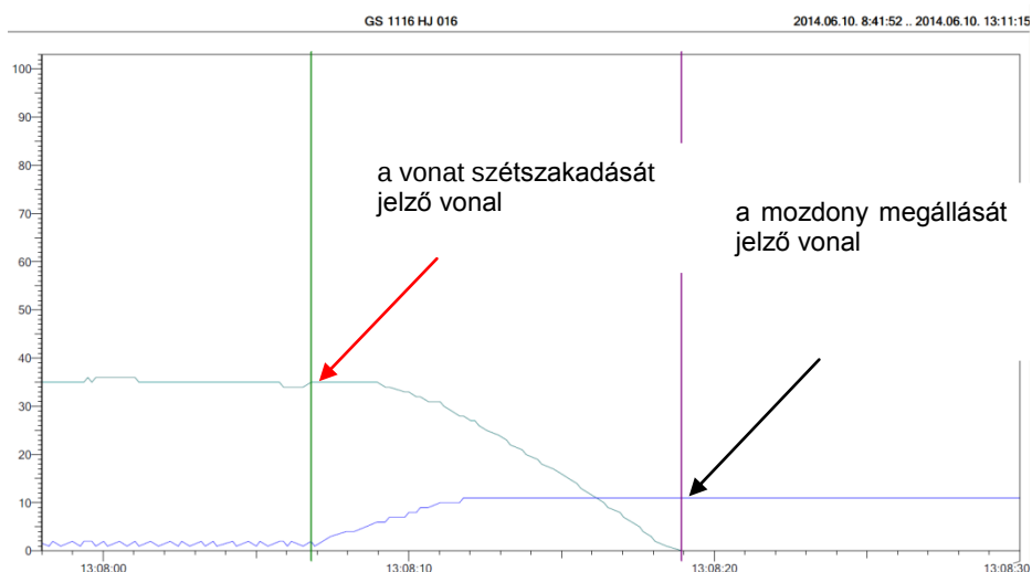
13. ábra: a 1116 016 mozdony menetirő regisztrátuma
