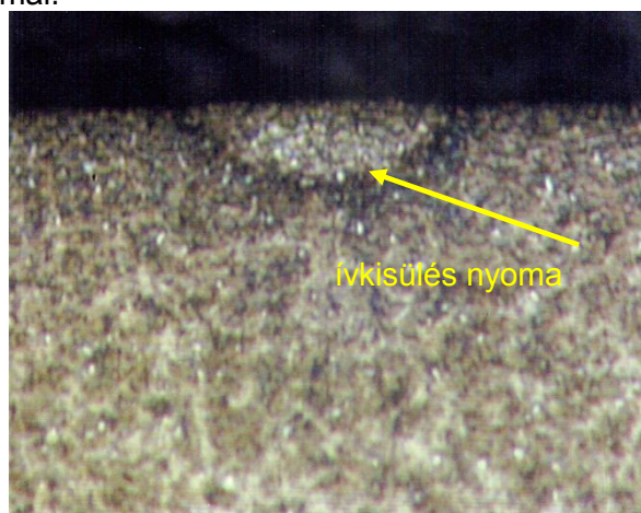
11. ábra: a csapágy belső gyűrű futópályán a villamos ív okozta sérülés N=1000x
