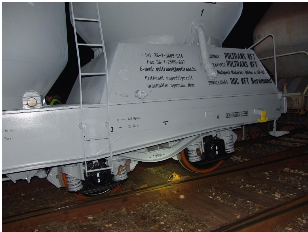
4. ábra: a szerelvény alatt maradt saru és egy kisiklott tengely
