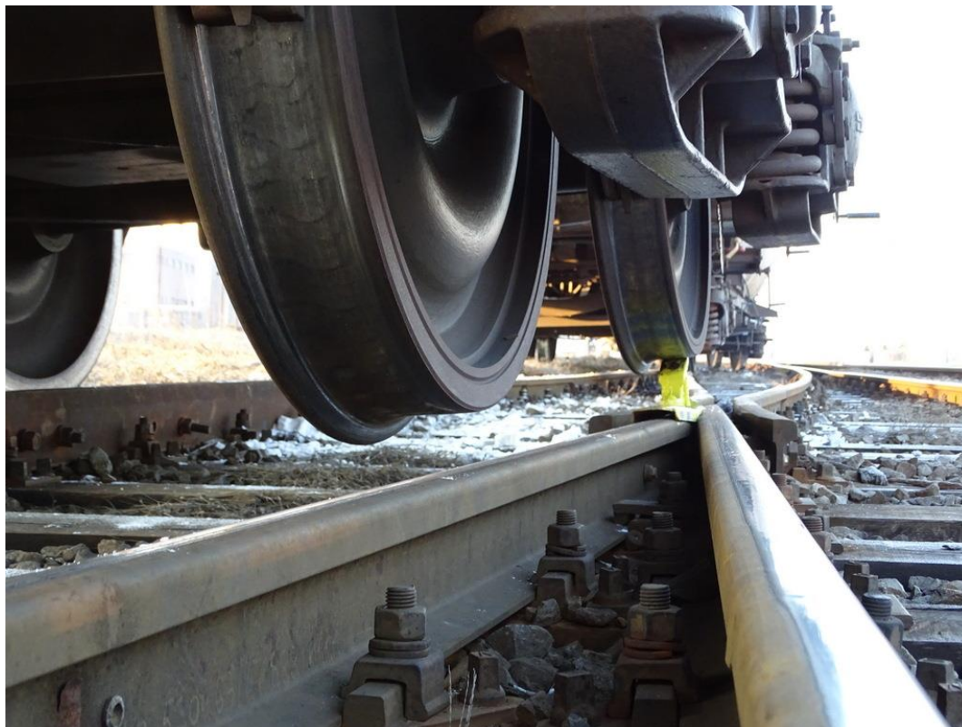
3. ábra: az elakadt saru egy kiemelkedett kerékkel
