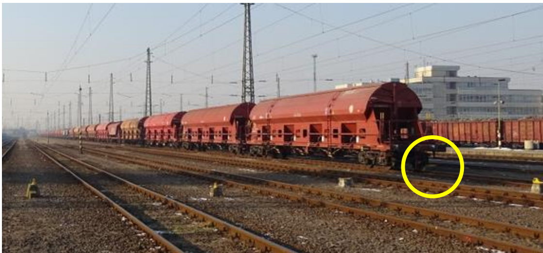
6. ábra: egy álló szerelvény az állomáson: rögzítősarú csak a képen látható, végpont felőli végén van
