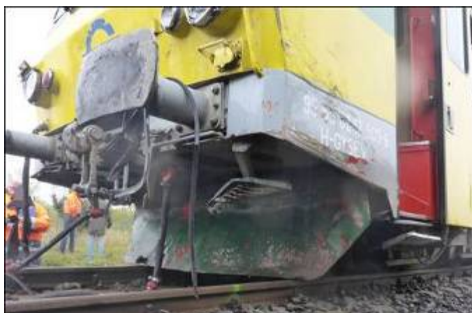
3. ábra: A megrongálódott vasúti vontatójármű (2015. október 7.)
