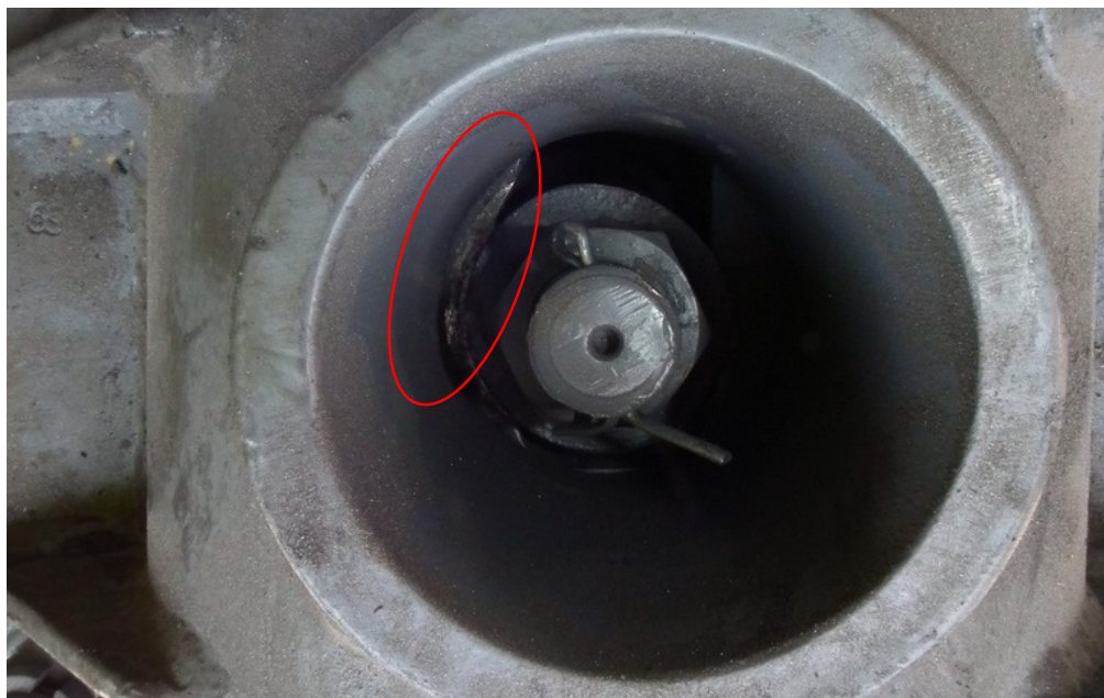
6. ábra: fényes felütközési nyom a csavar alatt (6. csap)
