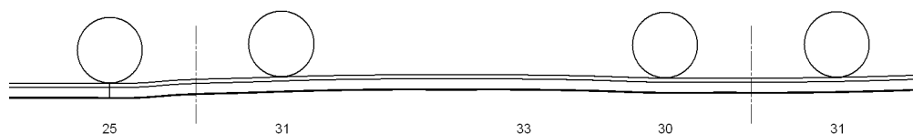
11. ábra: a mozdony kerekeinek közelítőleges helyzete a kisiklás kezdetén (az ábra 10x-es magassági torzítást tartalmaz)
