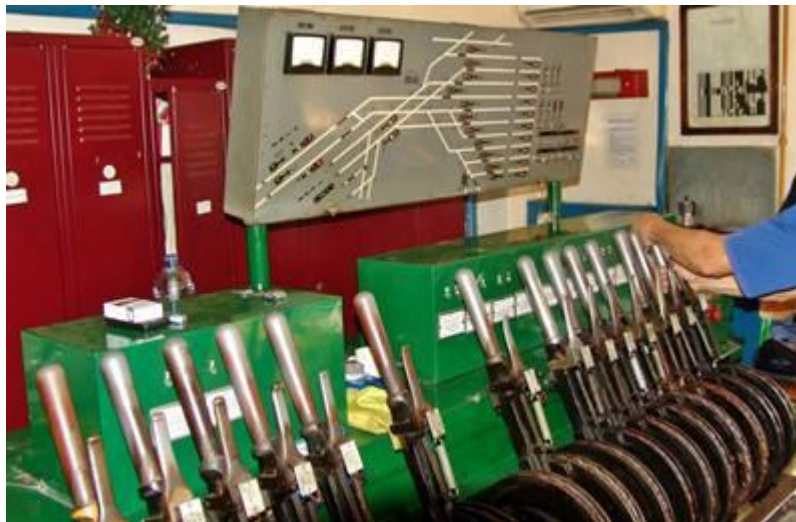
3. ábra: Az SH biztosítóberendezés a szolgálati hely II. sz. őrhelyén
