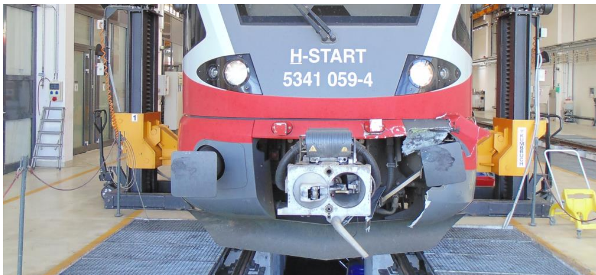
4. ábra: A járműben keletkezett károk.
