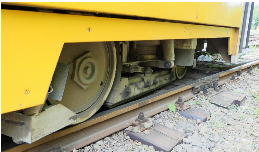
11. ábra: a júliusban kisiklott jármű siklott forgóváza
