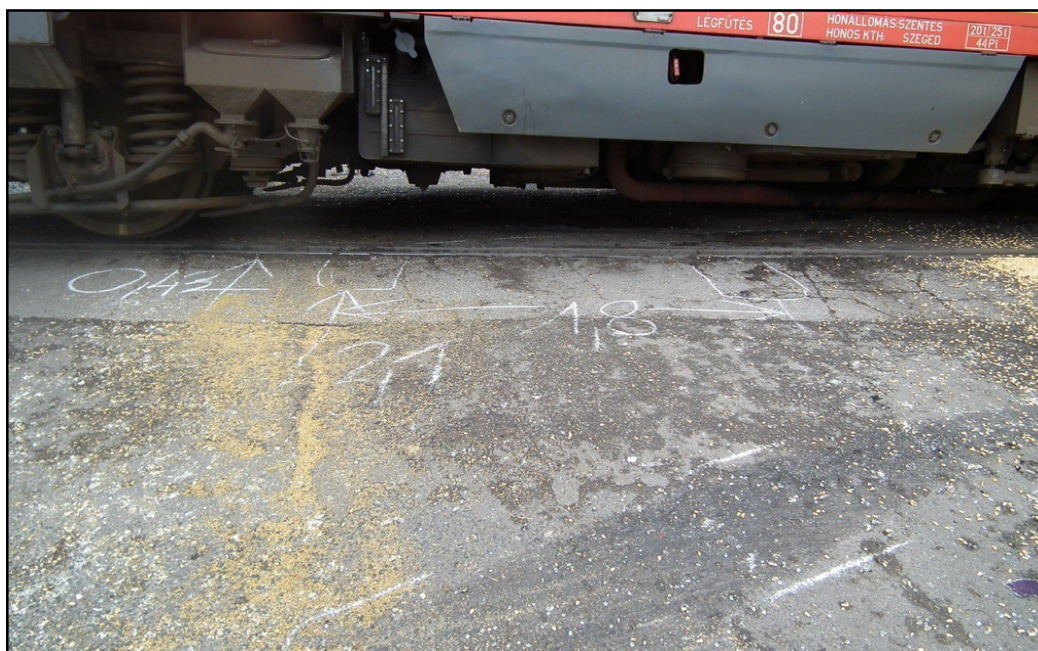
9. ábra: kerék sodródási nyom
